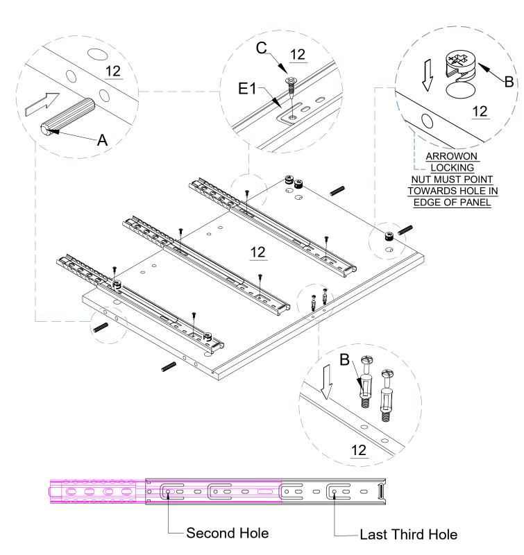
SCREW MUST BE INSERTED
